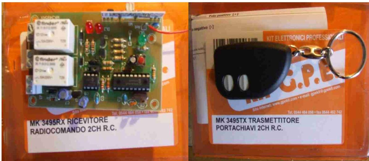
Ho pensato di alloggiare il ricevitore nello stesso vano dove era posto il vecchio, anche se è possibile montarlo in altre posizioni, anche nascoste, in quanto funziona ad onde radio e non ad infrarossi come il vecchio.
